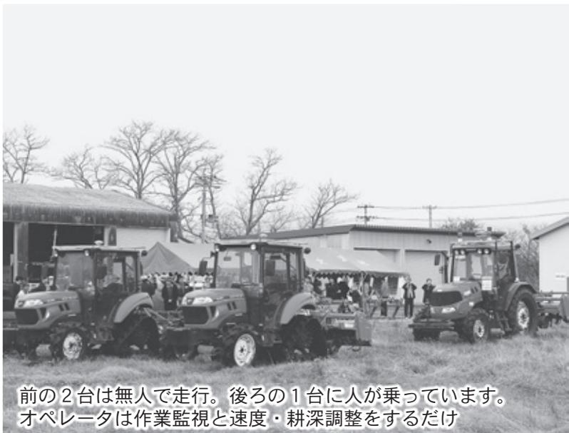
前の2台は無人で走行。後ろの1台に人が乗っています。オペレータは作業監視と速度・耕深調整をするだけ
