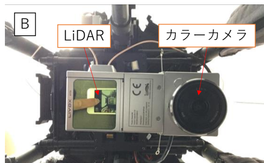
第 1 図 Matrice 600Pro (A) と LiAir V70 (B)
