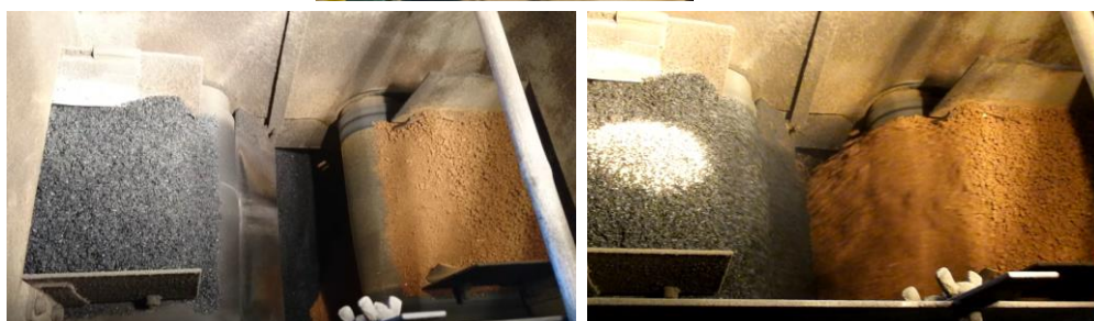
写真2 籾殻くん炭、焼土、育苗用肥料を自動で混合したあと、袋詰めされ軽量培土として農家に販売される。
