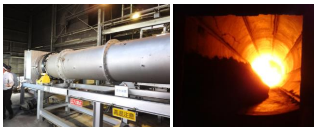
写真1ロータリーキルン方式の籾殻燻炭製造機
