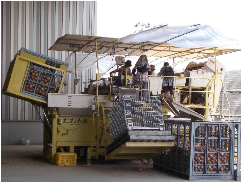
写真 定置式タッパによる作業
