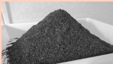
ボイラーから排出されたくん炭
