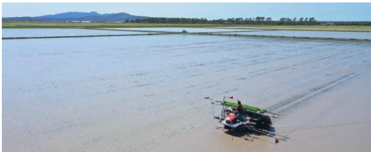
GPS直進アシストによる無落水での田植え作業
