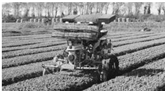
高収益作物の拡大のため共同利用を行っているタマネギ定植機
