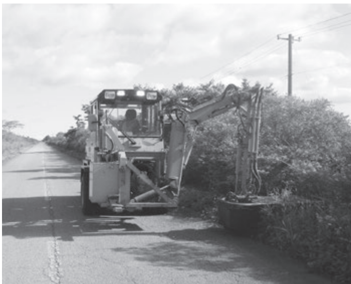
定期的に行われている路肩の草刈り
